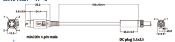
DC Power Cable (DC plug to mini DIN) 32002-002201-100-RS
